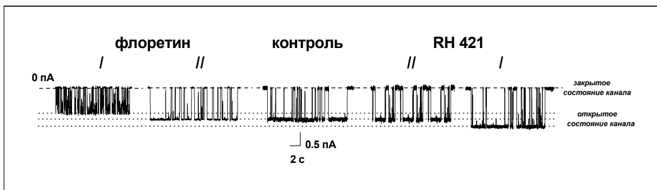
Рис. 6. Одиночные элементарные СМЕ-каналы в ДОФС:ДОФЭ:Хол:СМ-мембранах в отсутствие дипольных модификаторов (контроль) и в присутствии 20 мкМ флоретина или 5 мкМ RH 421. Липидные бислои омываются 0.1 М KCl при pH 7.4. Трансмембранное напряжение составляет -150 мВ.
