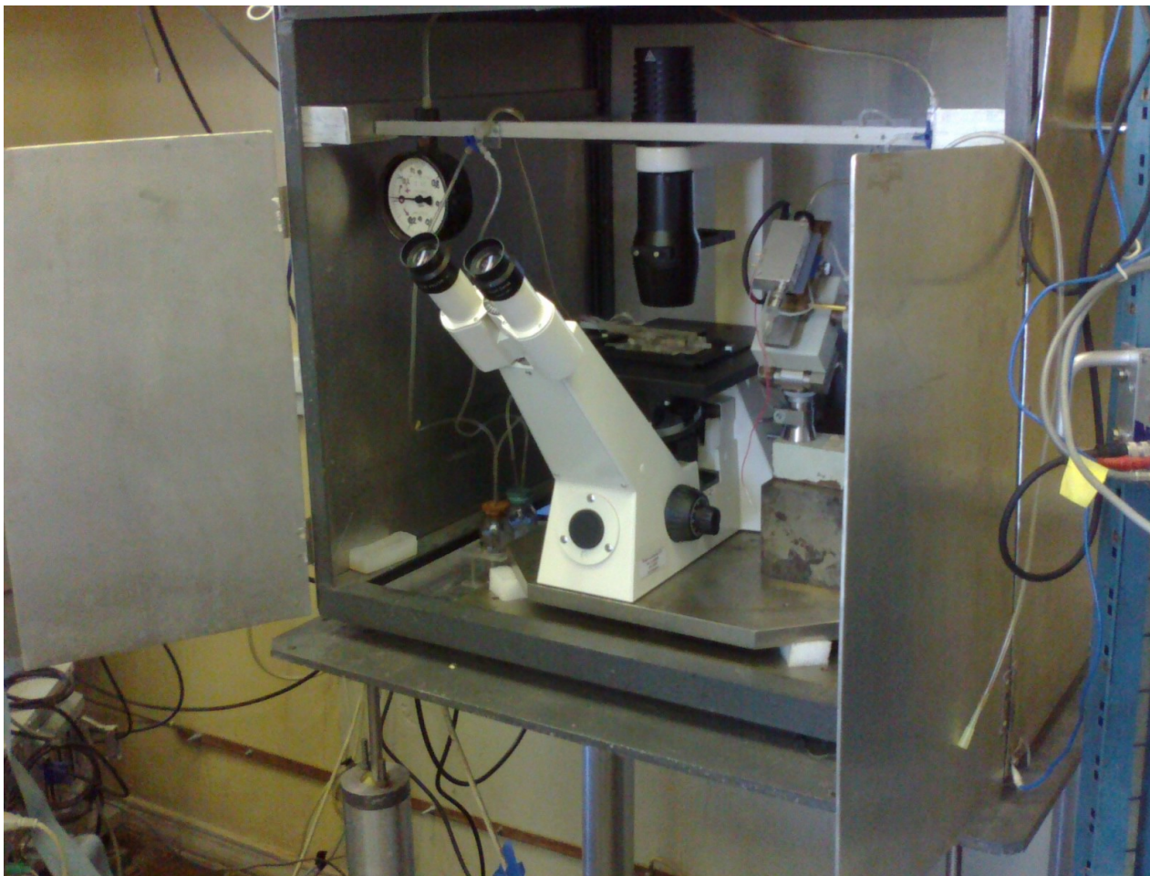
Рис. 16. Установка для патч–кламп экспериментов. Установка смонтирована на виброизолирующих основаниях и помещена в камеру Фарадея для защиты от паразитных электрических и магнитных полей. Для подведения пипетки к клетке используются механический и гидроманипуляторы. Контроль осуществляется с помощью инвертированного микроскопа Zeiss Axiovert 40 CFL.
